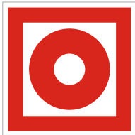
F 10 Кнопка включения установок (систем) пожарной автоматики
