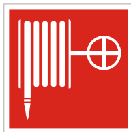
F 02 Пожарный кран
